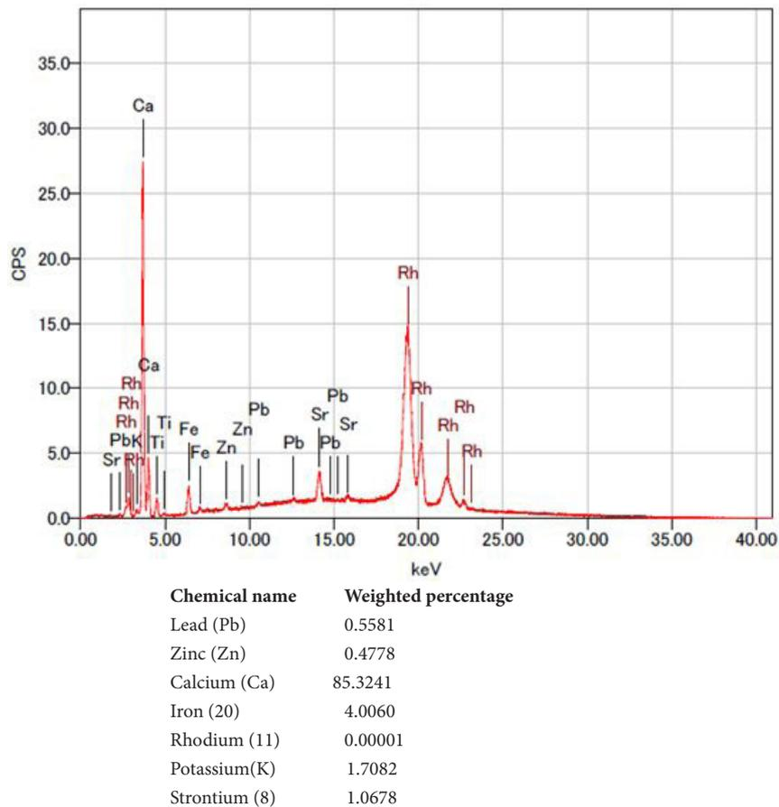
[CPS=count per second; ke V =Kiloelectron volt]
